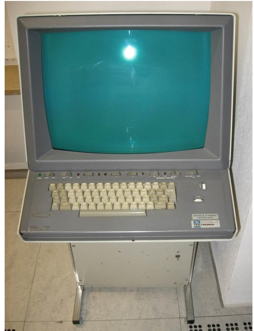
Operator-Konsole für CDC Cyber 960 (1988) TEKTRONIX 4014-1 Vektorgrafikbildschirm (1974)
