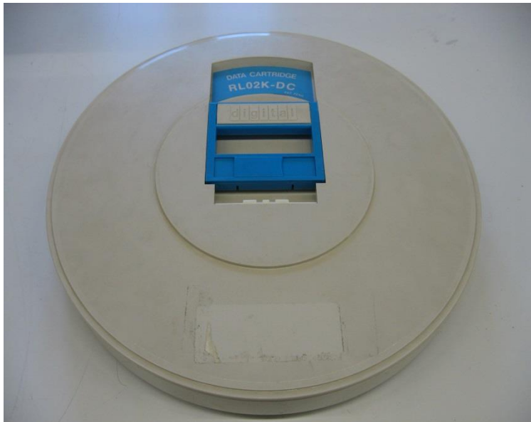
DEC Data Cartridge RL02 (1978) Kapazität ca. 10 MB Vorgänger RL 01 ca. 5 MB (1976)
