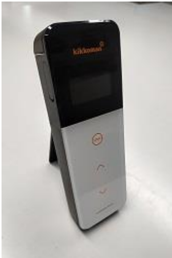
Abb. 9 Beispiel eines Luminometers (© Henrik Otto)
