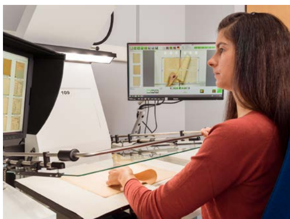
← Digitalisierung von Schriftgut mithilfe eines Aufsichtsscanners BArch, B 198 Bild-2020-1014-001 / Nobel, Jürgen
